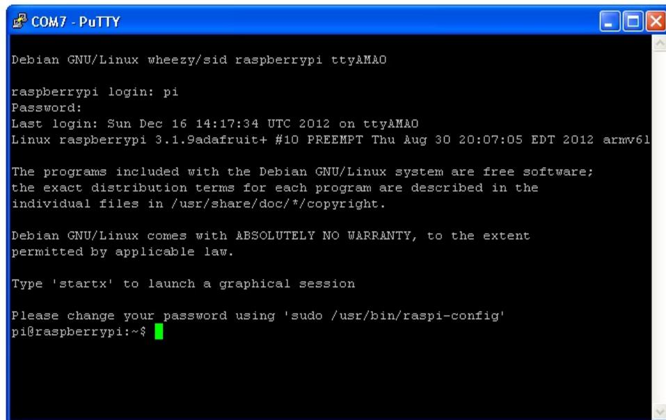
برای نمونه های جدید سیستم عامل raspberry، پیش فرض کلمه عبور pi و رمز عبور raspberry می باشد.
