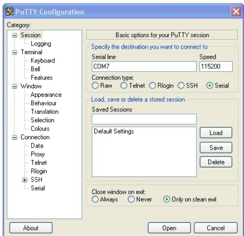
در بخش serial connection type نوع serial را انتخاب کنید، سپس سرعت را روی 115200 و خط سریال را com7 تنظیم کنید.
